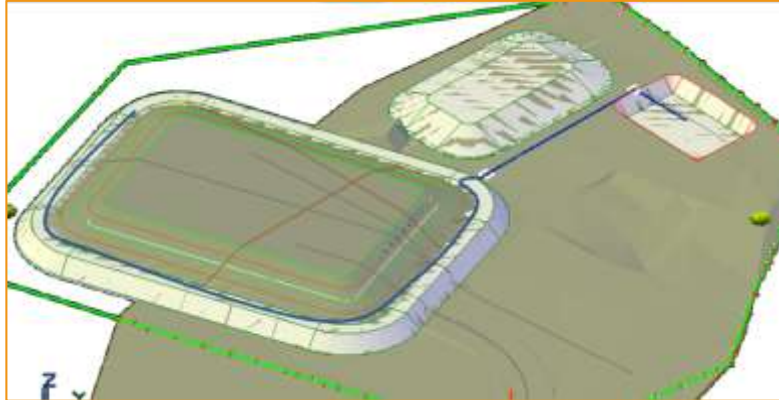
Figura 22 Esquema de Diseño del drenaje intermedio de lixiviados
