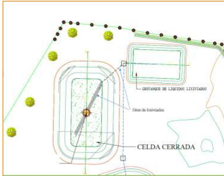
Figura 6 Captación y Conducción de Lixiviado
