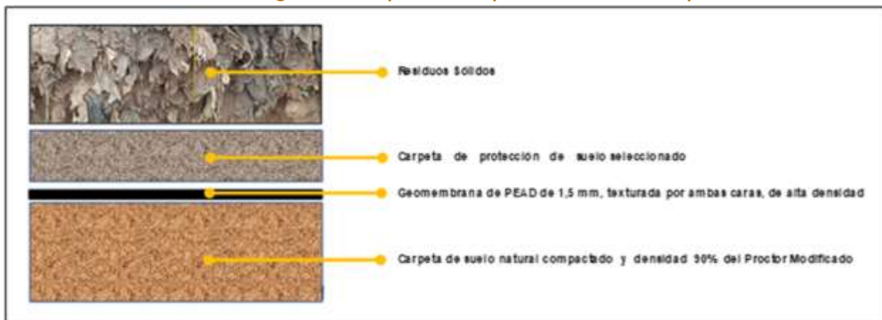
Figura 27 Paquete de impermeabilización empleado
